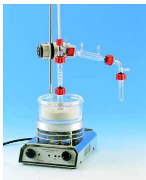
Figure 4 : montages types de chimie organique : distillation fractionnée, décantation, synthèse sous atmosphère inerte.
