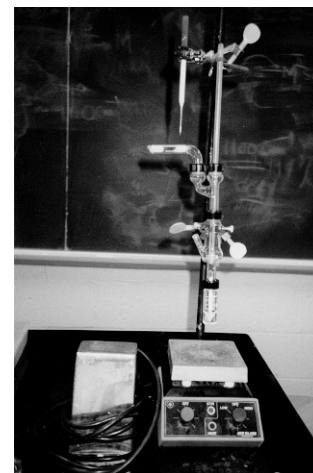
Figure 2 : montage de micro synthèse magnésienne aux Etats-Unis
