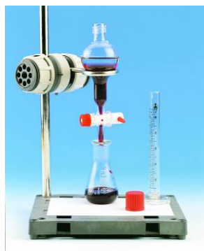
Figure 4 : montages types de chimie organique : distillation fractionnée, décantation, synthèse sous atmosphère inerte.
