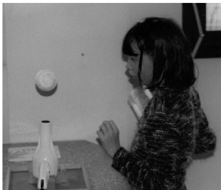
Figure 3 : Expérience contre-intuitive illustrant l'effet Venturi. ( Ebulliscience , Vaulx-en-Velin, janvier 2001).
